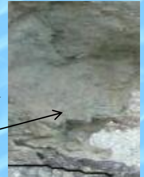
Κάθετη τομή 20 μ. Μέση τιμή (24 στρώματα) = 89% Ζεόλιθος τύπου-HEU Διακύμανση = 74-95%
